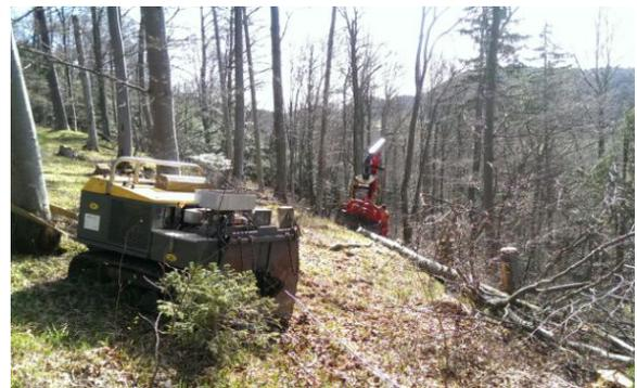
Fotos: Forwarder beim Einsammeln von bereitgestellten Sortimenten / Arbeit in Kombination Raupen- mit dem Forstspezialfahrzeug
